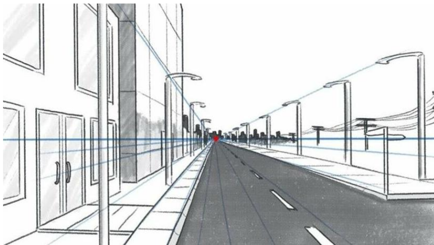
Рис. 1. Зміна розмірів предметів відносно точки зору та лінії горизонту з однією точкою сходження.
